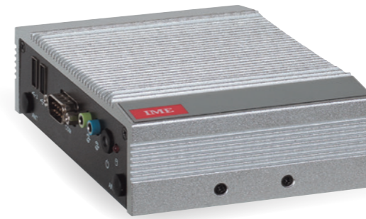
Web serveur pour 255 adresses Modbus ou 255 modules impulsions (réf. SXWS255).
